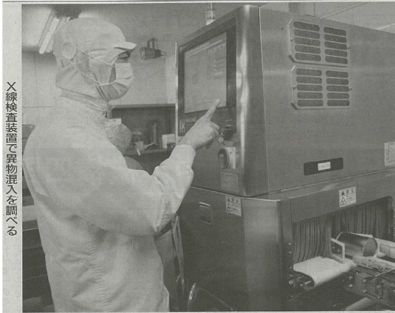
X線検査装置で異物混入を調べる
